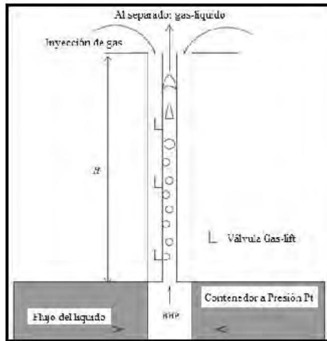
Figura 1-1: Esquema del proceso de inyección de gas en una columna de aceite para disminuir su densidad razón por la cual sale por el borde superior de la tubería de producción. Adaptado de [86].
