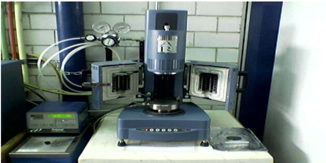
Figura 6.5. Reómetro TA Instruments AR-1000N
