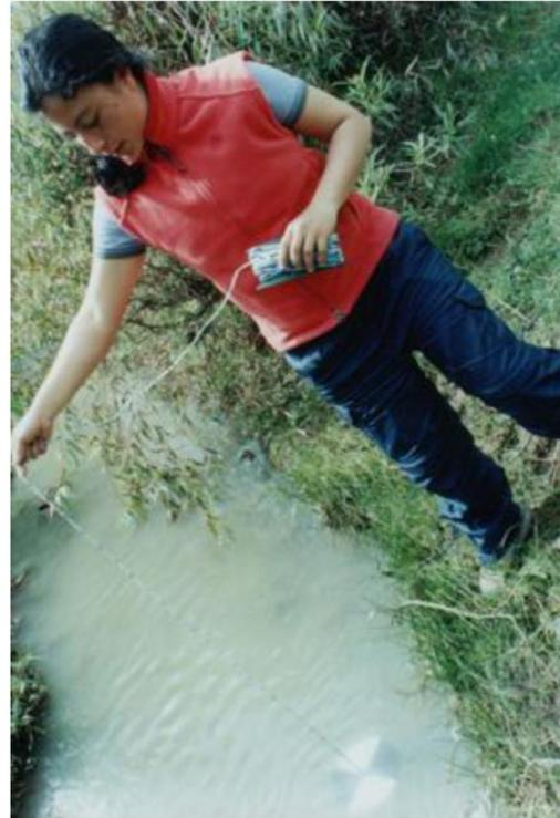
Fig. 4. Medición de transparencia con el disco de Secchi
