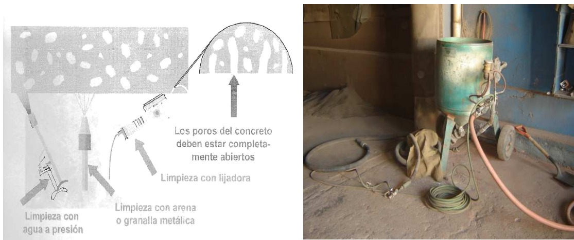
Fig. III.5.1. Limpieza del concreto antes de la aplicación de la fibra de carbono.
