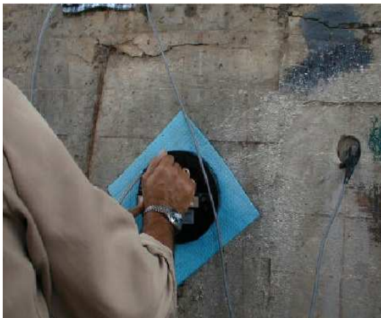
Fig III.8.2 (Izquierda). Fotografía de una zapata de un puente en donde se muestra el sensor utilizado para determinar la velocidad de corrosión de una de las varillas afectadas por corrosión.
