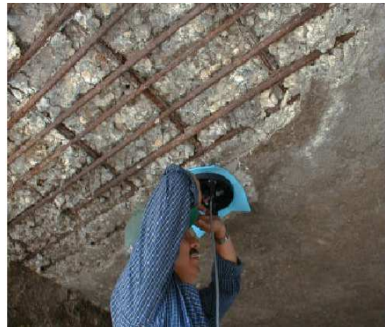
Fig III.8.2 (Izquierda). Fotografía de una zapata de un puente en donde se muestra el sensor utilizado para determinar la velocidad de corrosión de una de las varillas afectadas por corrosión.
