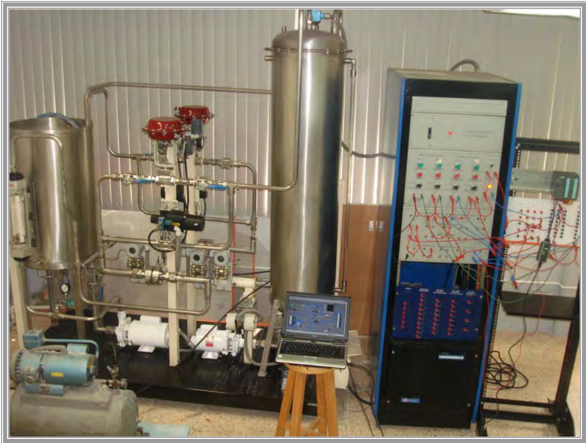
Figura 4.32. Foto de la planta piloto para el proceso de Control y Monitoreo SCADA.
