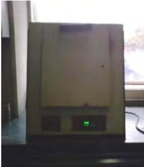
Figura 3.14. Mufla Linberg para el tratamiento térmico
