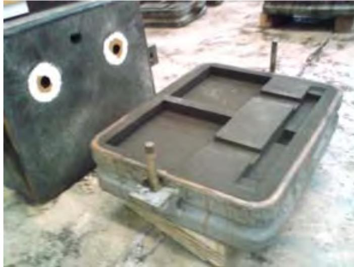
Figura 3.2 Moldes de arena para la obtención de placas de hierro nodular
