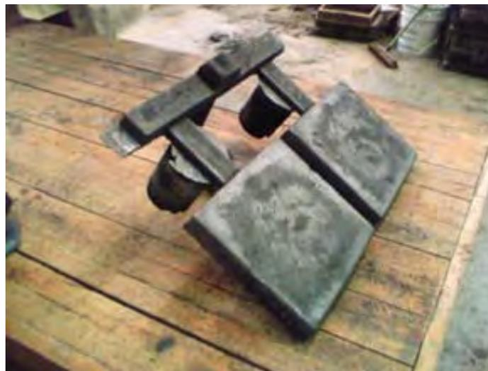
Figura 3.3 Placas de hierro nodular obtenidas después de la fundición
