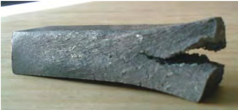
Figura 4.8. Probeta de prueba fracturada después de 3 deformaciones.
