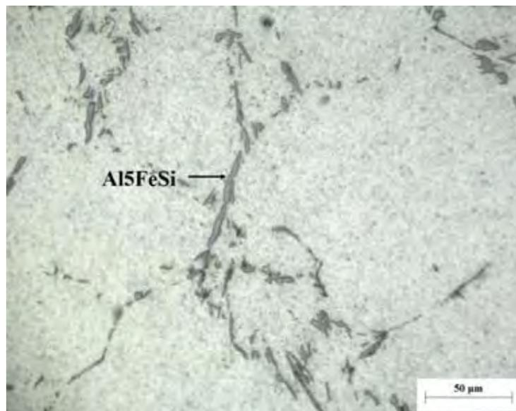
Figura 1.2 Imagen a 50X donde se presentan las agujas alargadas de  $\text{Al}_5\text{FeSi}$ .
