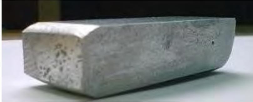
Figura 3.17. Probeta para laminar con un desbaste en ángulo
