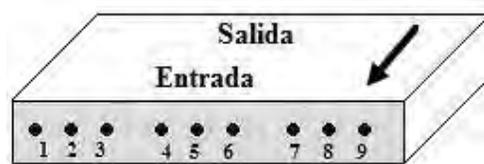
Figura 4.21. Distribución de las partículas en el compósitos con 70% de deformación con Sr. Representación esquemática de las zonas cuantificadas y dirección de laminado.
