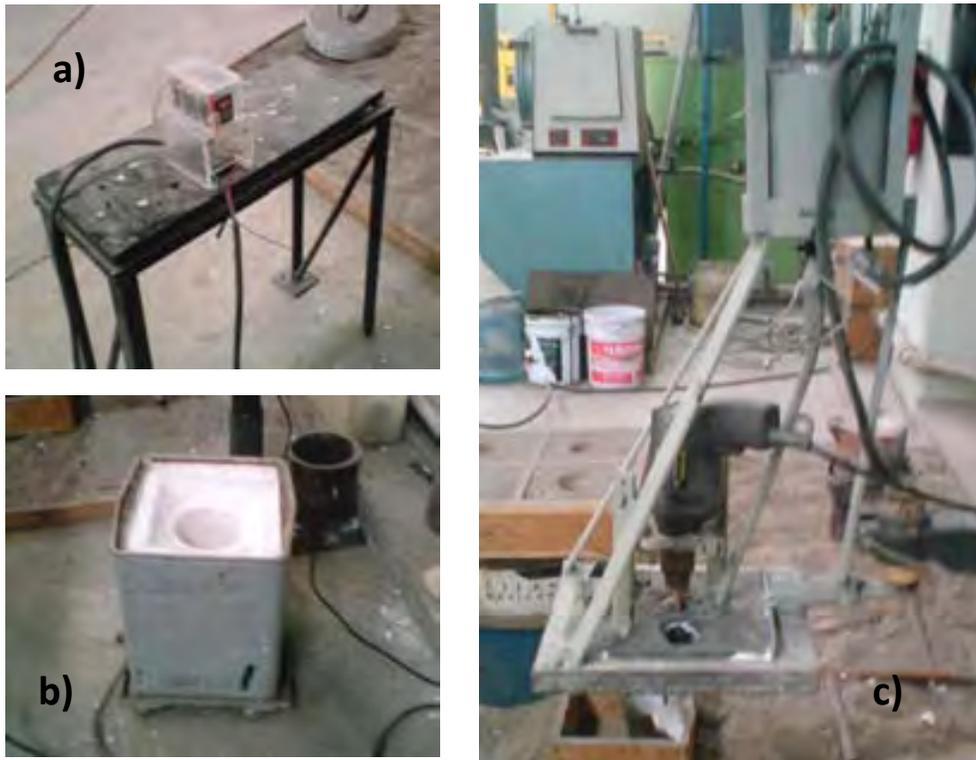
Figura 3.7. Equipo ocupado para fabricar el compósito. a) Controles del horno; b) Horno de resistencia; c) Taladro con la hélice para producir el vórtice.
