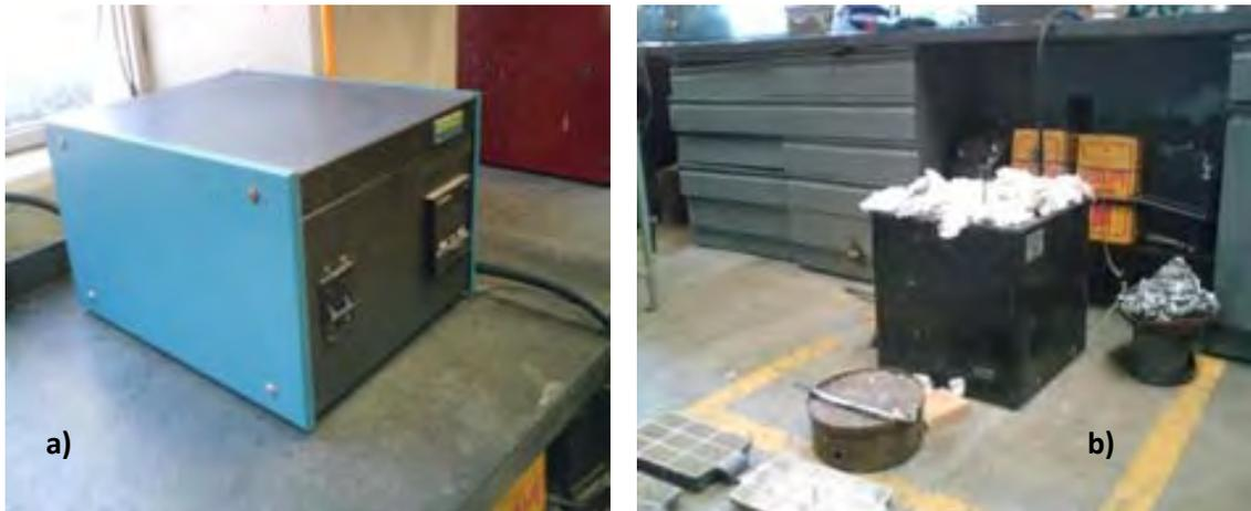
Figura 3.5. Horno ocupado para fundir el aluminio 6061. a) Controles del horno; b) Horno con el crisol
