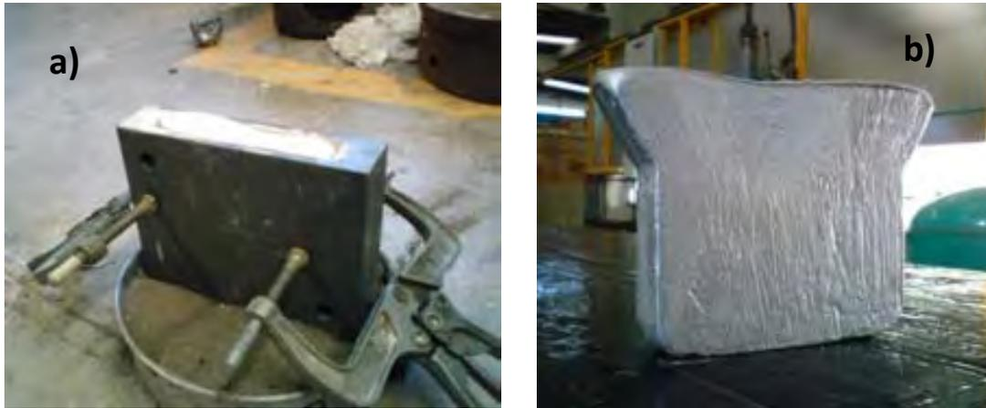
Figura 3.8. Lingote de compuesto. a) Lingotera; b) Lingote final
