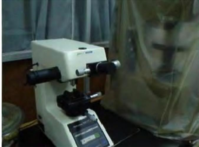
Figura 3.22. Micro durómetro Vickers utilizado
