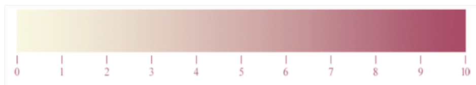
Figura 3.1: Escala de detección para la obtención del número de Schönbein
