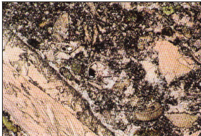
Fig. 2.10. Roca caliza compacta (imagen ampliada 63 veces).
