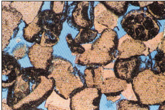
Fig. 2.9. Roca Caliza porosa (imagen ampliada 63 veces).
