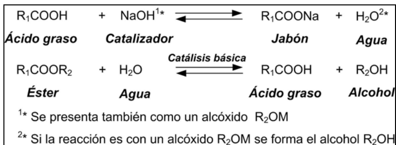
Fig. 3 Reacciones indeseables durante la reacción de esterificación.
