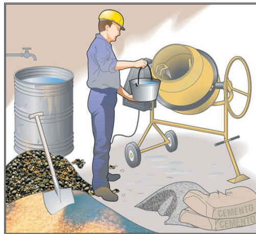
Fig. 1.1 Elementos que componen el concreto
