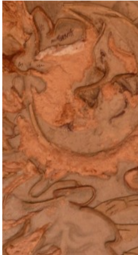
Fragmento de una placa cartográfica preconstruida con papel mache, en la que se observan relieves de la mezcla de mache con mayor densidad y menor porosidad.
