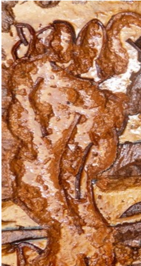
Fragmento de una placa cartográfica preconstruida con papel mache protegida con goma laca, se observa que el grado de porosidad no es disminuido por la goma.
