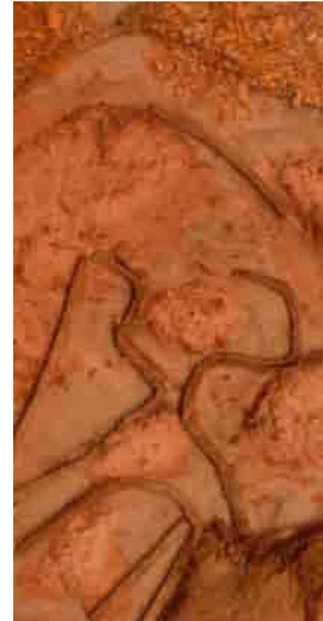
Fragmento de una placa cartográfica preconstruida con papel mache, en la que se observan relieves de la mezcla de mache con resitol dando como resultado mayor porosidad.
