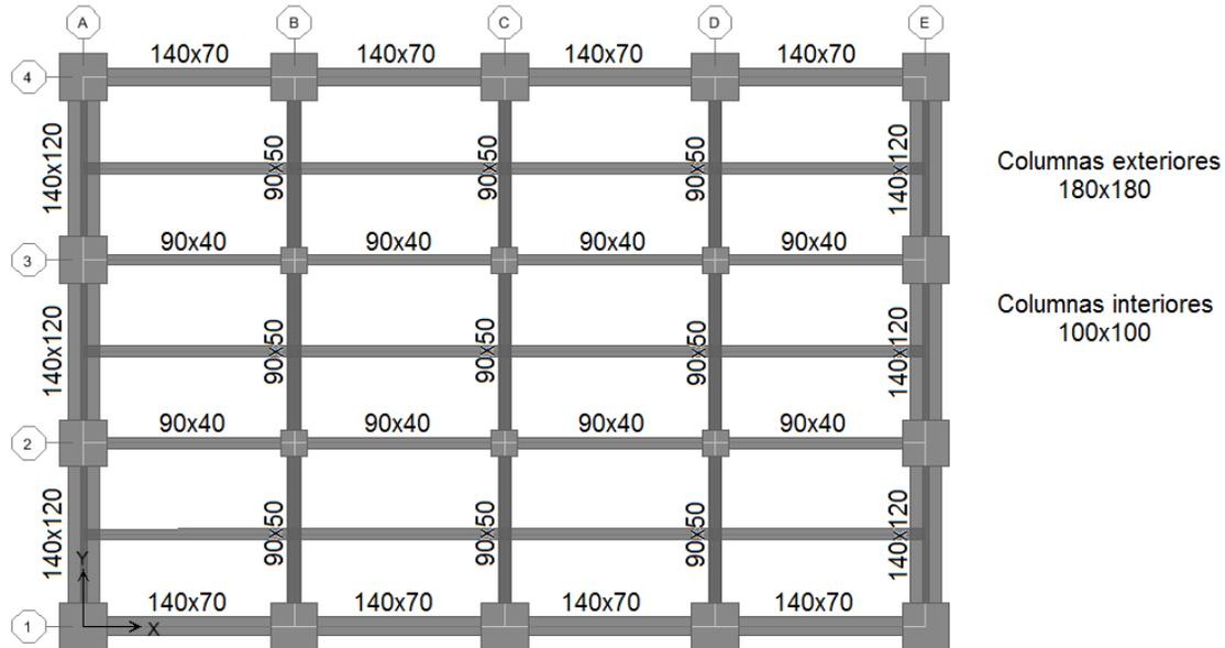
Figura 5.16. Planta nivel 1. Secciones de elementos en cm.
