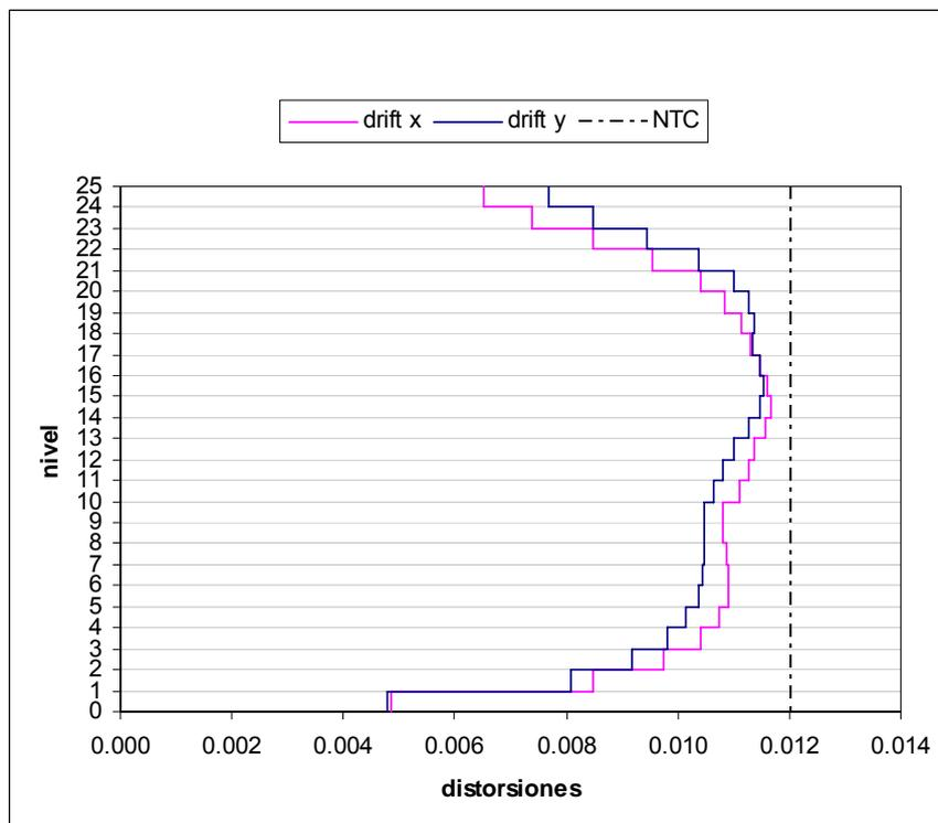
Figura 5.18. Distorsiones de entre piso.
