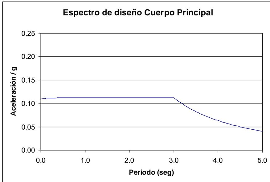
Figura 5.1. Espectro de diseño del cuerpo principal.
