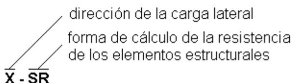
X RCDF – la carga lateral se aplica únicamente en la dirección al eje “x”. La resistencia de los elementos estructurales está dada por las ecuaciones del RCDF sin factores de reducción de resistencia a flexión ( $F_R=0.9$ ) y cortante ( $F_R=0.8$ ).
