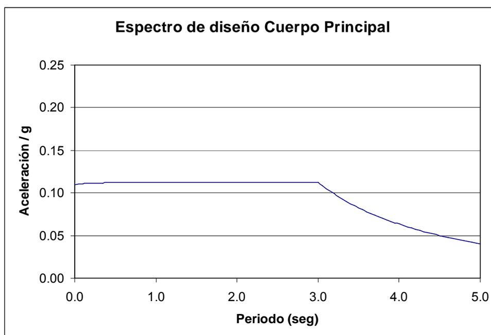
Figura 5.4. Espectro de diseño del cuerpo principal.
