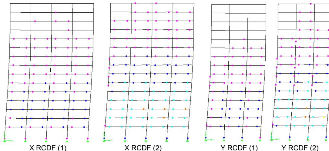
Figura 4.3. Ejemplo de formación de articulaciones en la estructura. De izquierda a derecha: fluencia en el marco del eje 1 (punto de control 1 en la curva X RCDF); antes del colapso en el marco del eje 1 (punto de control 2 en la curva X RCDF), fluencia en el marco del eje A (punto de control 1 en la curva Y RCDF), antes del colapso en el marco del eje A (punto de control 2 en la curva Y RCDF).
