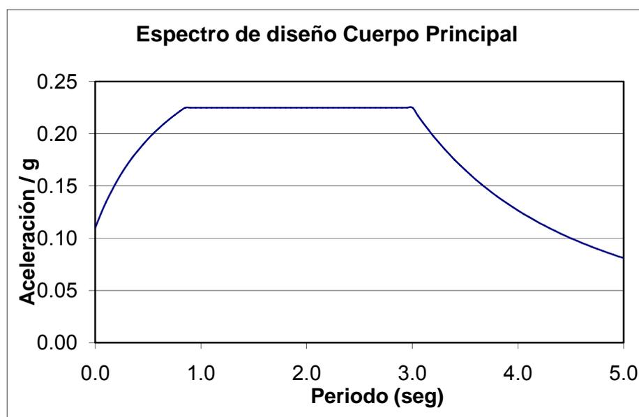
Figura 5.7. Espectro de diseño del cuerpo principal.
