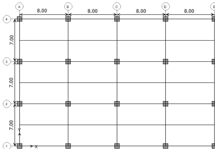
Figura 2.1. Planta tipo. Cotas en metros.
