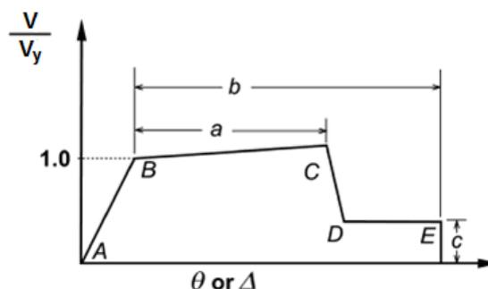
Figura 3.1. Curva esfuerzo-deformación.
