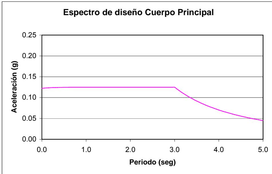
Figura 5.17. Espectro de diseño del cuerpo principal.
