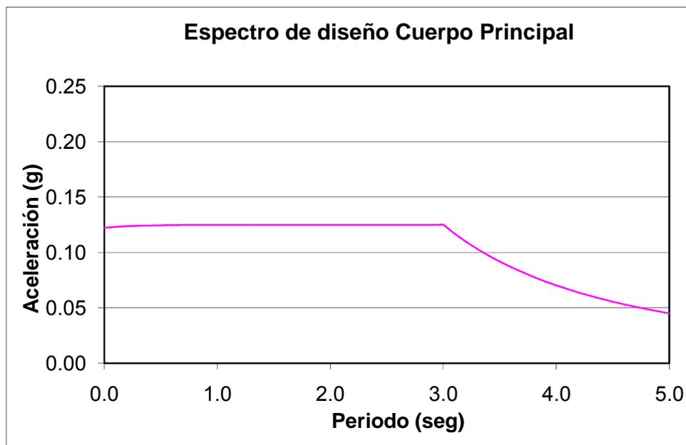
Figura 5.13. Espectro de diseño del cuerpo principal.
