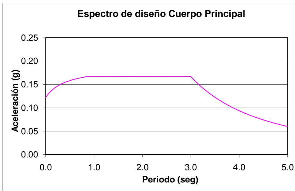
Figura 5.21. Espectro de diseño del cuerpo principal.
