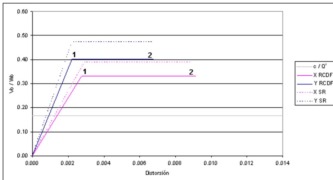
Figura 4.2. Curva de capacidad simplificada mostrando el coeficiente sísmico y 4 casos de análisis por estructura. Puntos de control (1, 2)
