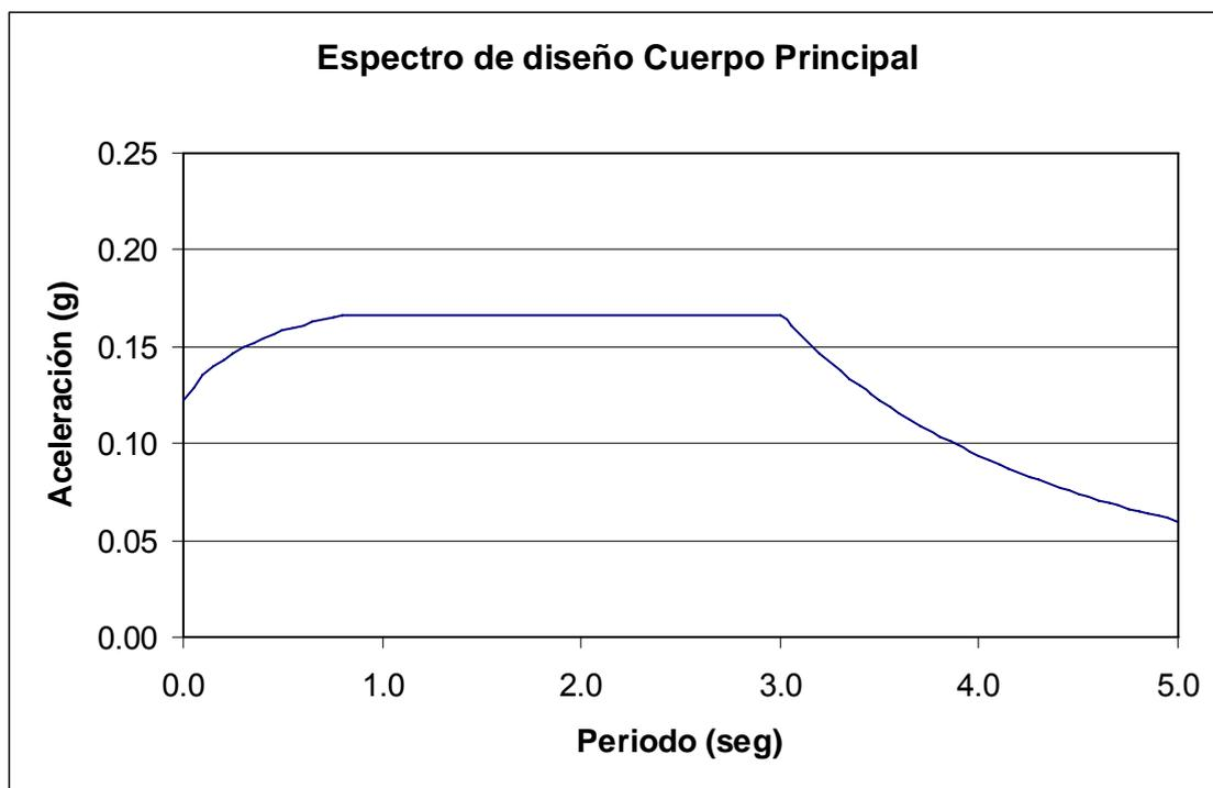
Figura 5.29. Espectro de diseño del cuerpo principal.
