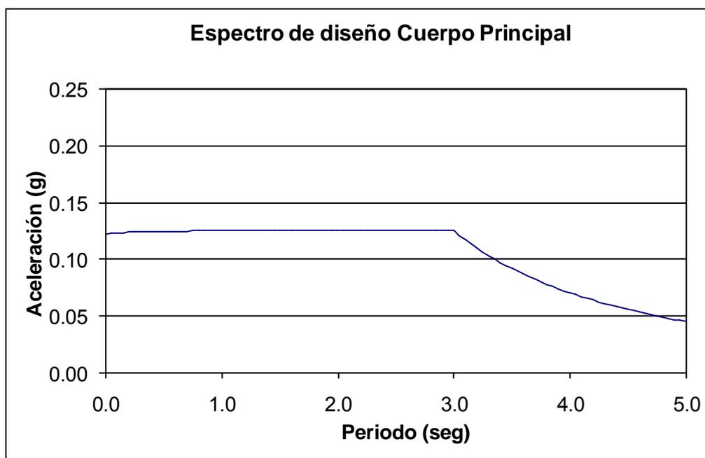
Figura 5.10. Espectro de diseño del cuerpo principal.
