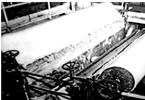
Antes del bloqueo se elimina el agua que contiene la pulpa mediante el empleo de unos rodillos perforados que dan salida al líquido.
