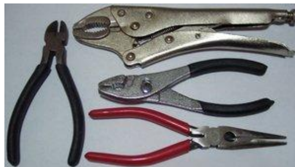
Figura 3.2 Pinzas de taller: Pinzas de corte (izquierda), Pinzas de presión (arriba), Pinzas mecánicas (en medio), Pinzas de punta (abajo)
