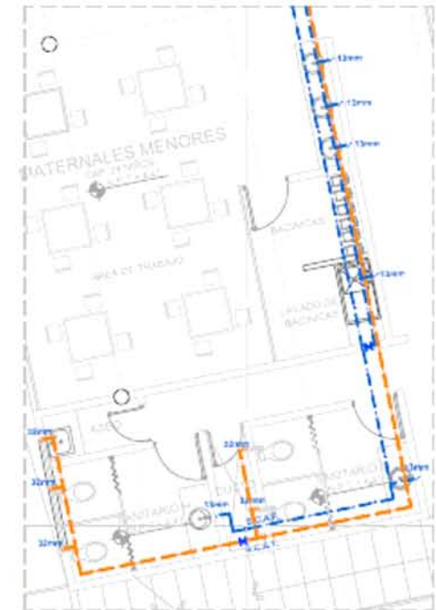
D-05 MODULO SANITARIO PERSONAL - AREA DE BACINICAS
