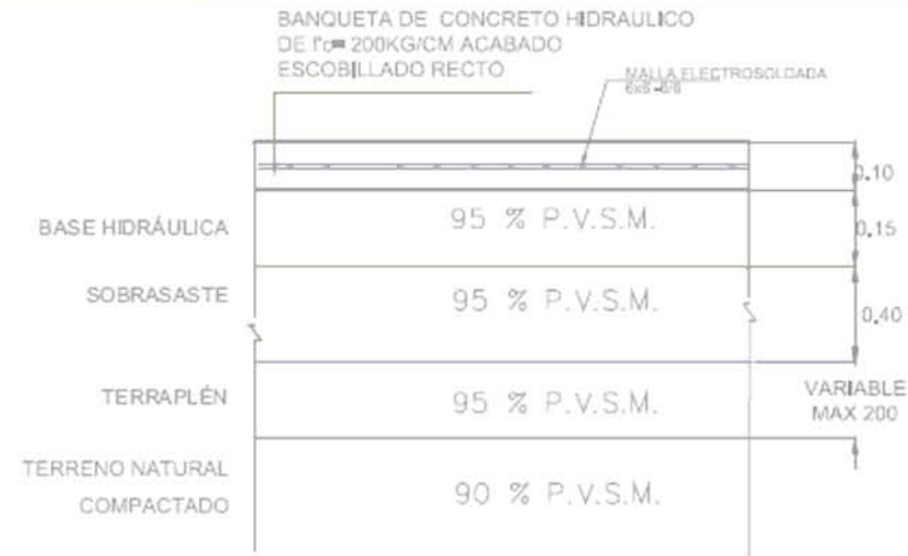
SECCIÓN - BANQUETA DE CONCRETO
