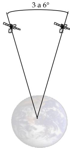
Fig I.7 Separación espacial entre satélites en órbita geosíncrona
