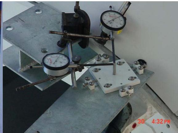
Alineación de poste de antena y calibración de detectores de ángulo
