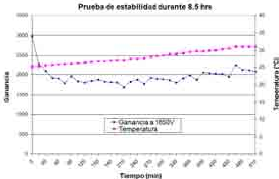
Figura 3.10: En esta gráfica se comparan los valores de la ganancia con la temperatura del gas tomados a intervalos de 30 minutos durante un tiempo total de 8 horas y media. El voltaje en el RETGEM fue de 1,650 V.
