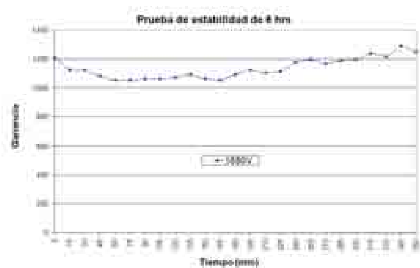
Figura 3.6: Se grafica nuevamente la ganancia en función del tiempo pero con mediciones cada 15 minutos durante un lapso de 6 horas. El voltaje sobre los electrodos del detector en este experimento fue de 1,650 V.
