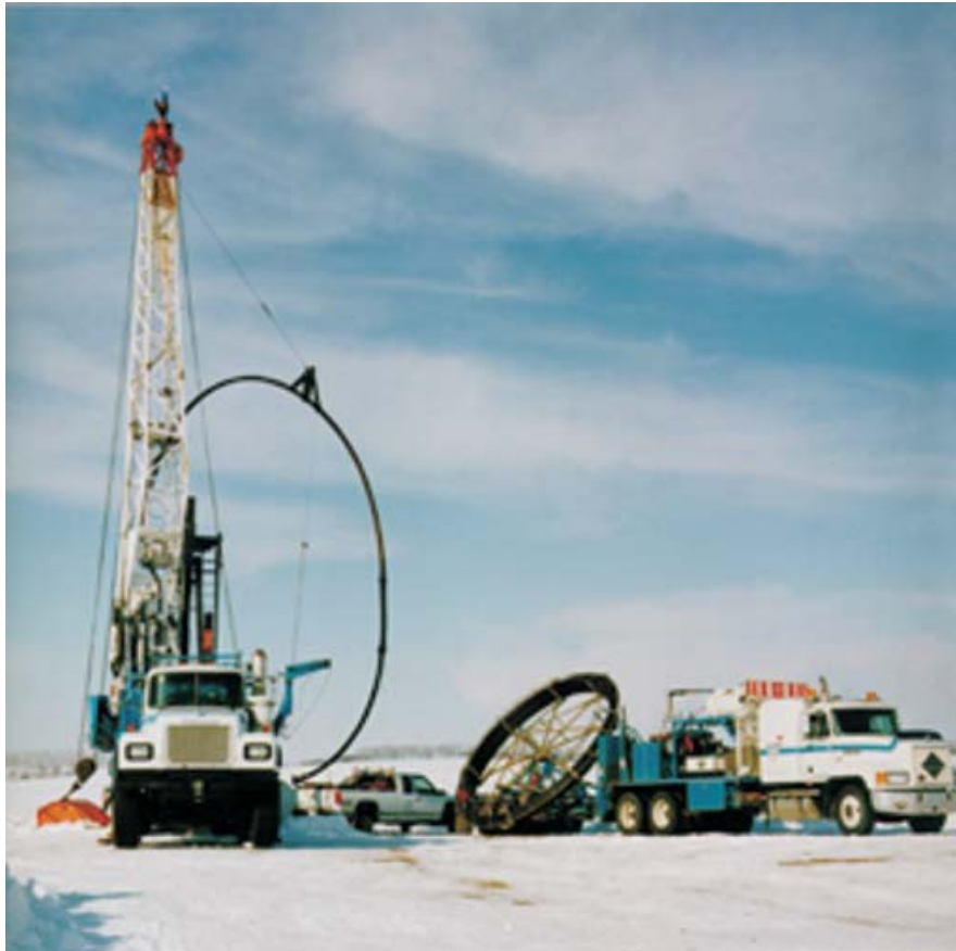
Figura 4.16 La varilla continua es enrollada en carretes y es introducida al pozo de manera similar a la tubería flexible.
