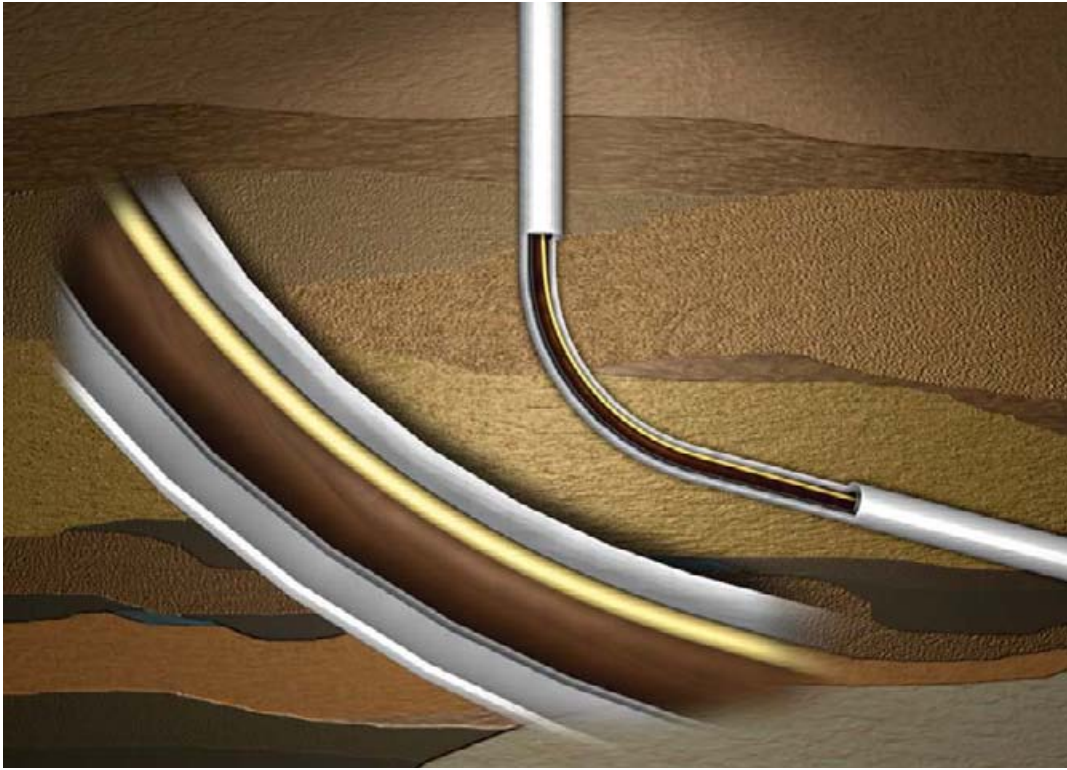
Figura 4.17 Las cargas de contacto que con la varilla convencional estaban concentradas sobre los coples, o centralizadores, en la varilla continua estas cargas se concentran a lo largo de la sección que está en contacto con la tubería.
