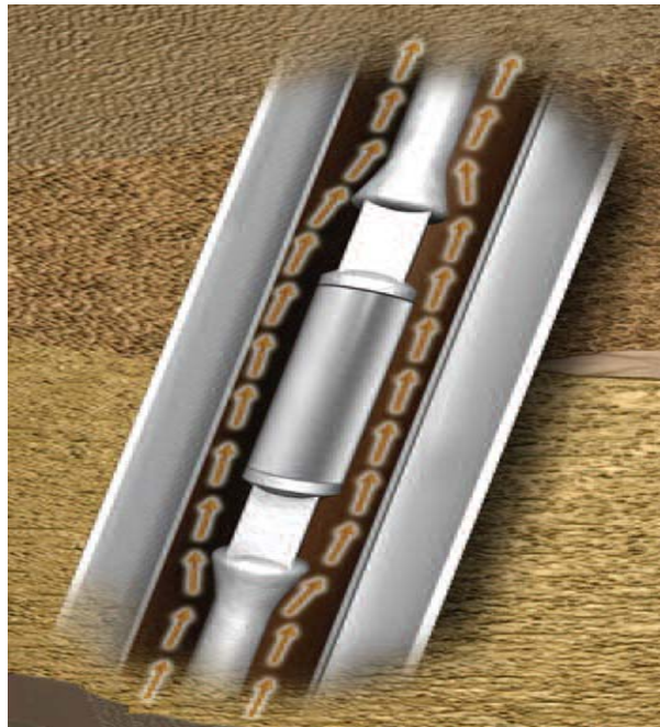
Figura 4.11 Los coples y centralizadores son restricciones del flujo. Estas restricciones provocan grandes pérdidas de presión a lo largo de la tubería de producción.
