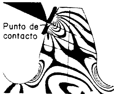
Figura 2.14 Concentración de esfuerzos en dientes de engranes[21].
