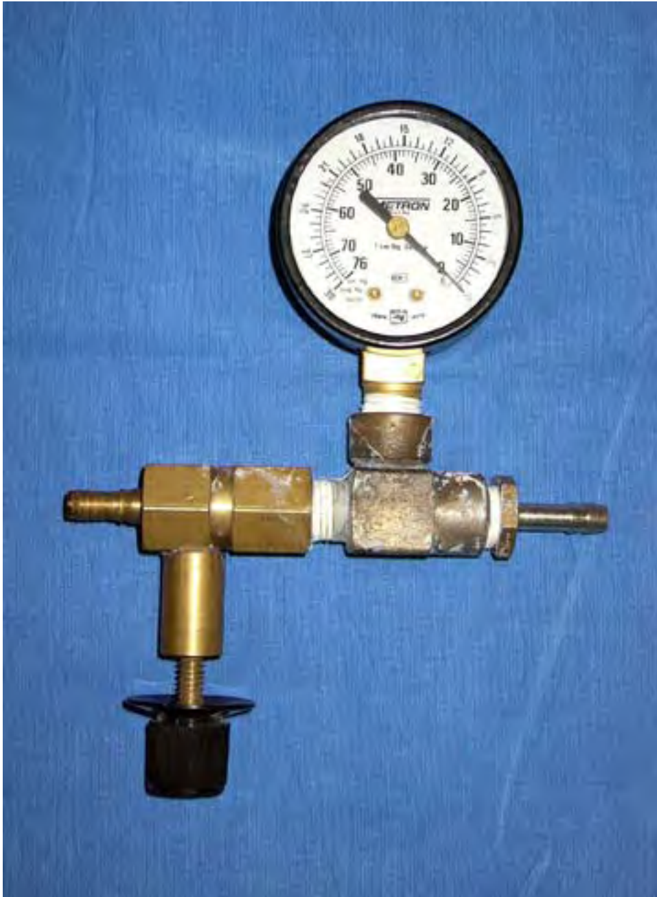
Figura 1. Manómetro de presión negativa, instalado a válvula bidireccional, con perilla que regula flujo de aire para controlar nivel de presión subatmosférica a administrar.
