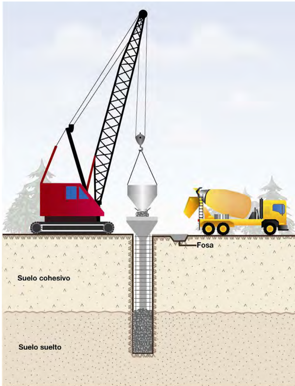
Fig. 1.21 Método de lodos, colado
