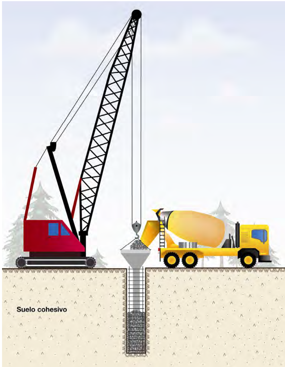
Fig. 1.5 Método seco, colado
