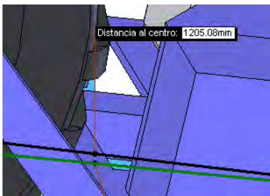
Figura 5.2 Modificaciones al chasis para aumentar la distancia entre el centro de gravedad y el centro de rotación de la rueda motriz.
