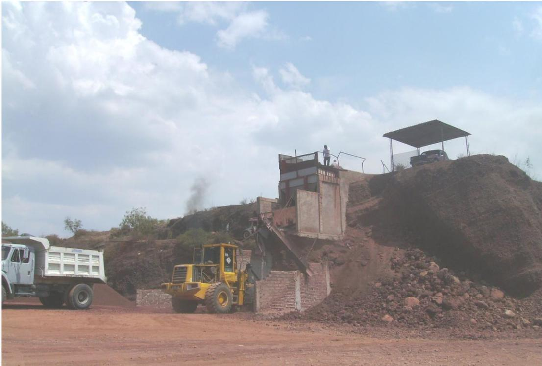
FIG. 2.1.2.2 CRIBADO DE MATERIAL
