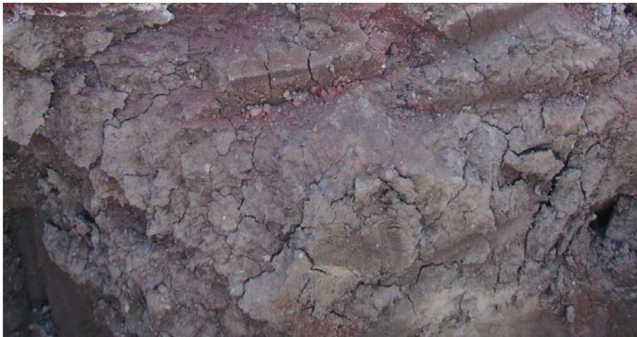
FIG. 3.1.5.2 CORTE EN MATERIAL ARCILLOSO DESHIDRATADO
