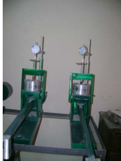
Prueba de consolidación
