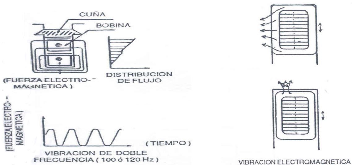
Figura 3.3 Vibración de una Bobina por acción electromagnética
