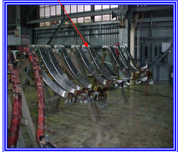
Fotografías 5.26 y 5.27 Se muestra las bobinas con el aislamiento original y después sin el aislamiento
