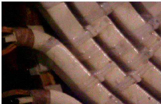
Fotografía 5.19 Amarres de bobinas inferiores contra los yugos o soportes
