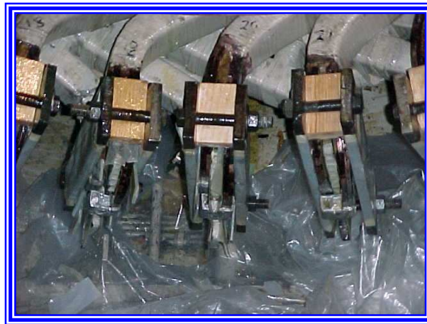
Fotografía 5.38 Prensado de cabezales apretando los tornillos
