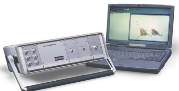
Figura 4.11 Sistema PDA Premium de captura de descargas parciales con técnica diferencial de discriminación.
