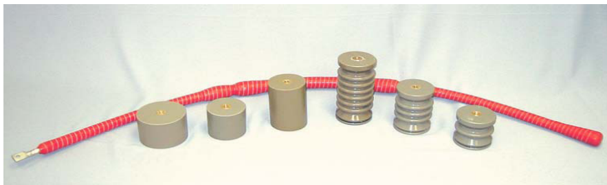
Figura 4.10. Captadores de DP capacitivos. Con una reducida inversión solo en los captadores se puede dejar la máquina monitorizada aprovechando los gastos y tiempos asociados a una parada y ejecutarse ensayos on-line programados de modo periódico con equipos de medida propios o subcontratados.
