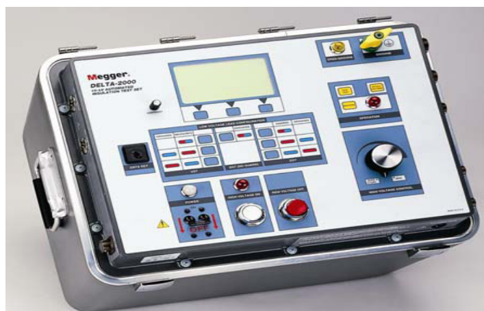
Figura 4.3. Equipo de medici3n autom3tica de tangente de delta, modelo Delta 2000.
