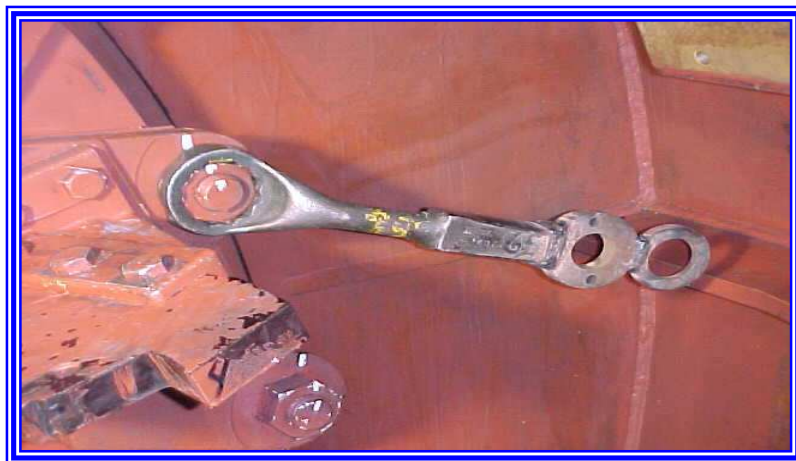
Fotografía 5.11 Reapriete de tornillos pasantes del laminado del estator
