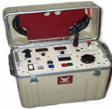
Figura 4.9 Sistema de ensayo de Sobretensión DC (0-75kV).
