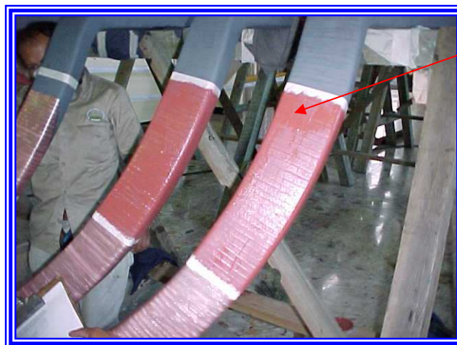
Fotografía 6.30 Parte curva de bobina con pintura R4
