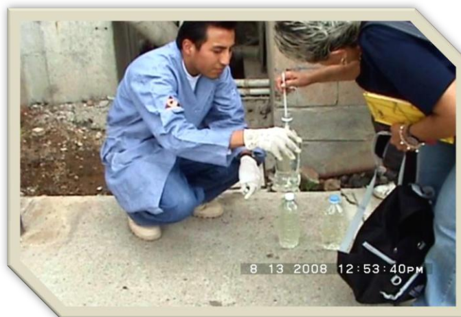
Fig. 5.2 Verificación de temperatura y pH del agua residual tratada.
