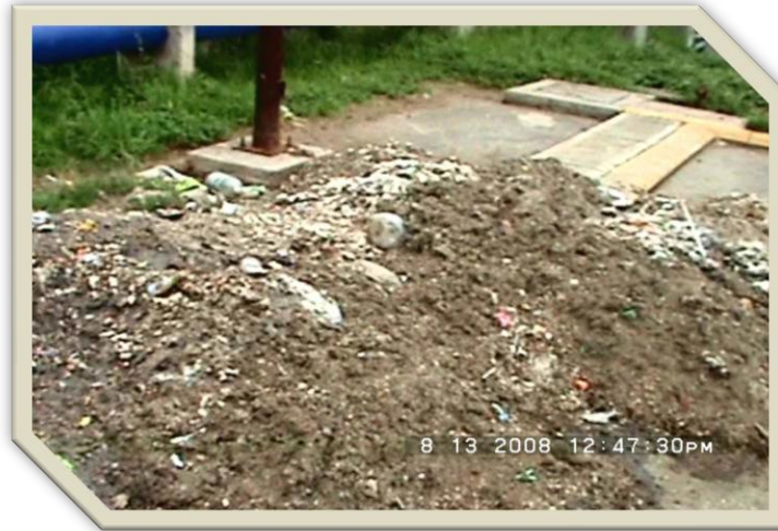
Fig. 5.4 Residuos sólidos extraídos del pretratamiento de agua residual.
