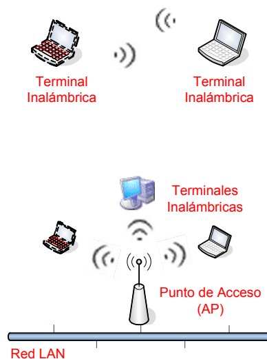
Figura 1.4. Arriba, topología Ad-hoc . Abajo, topología infraestructura en redes Wireless .
