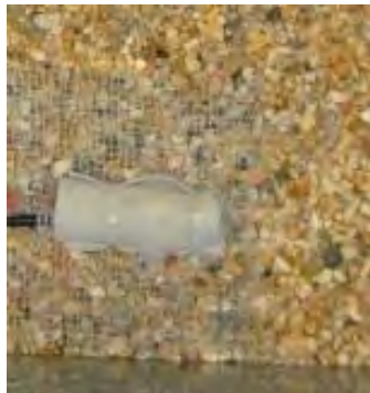
Figura V.10 Sensor de presión sujeto a una malla, colocado en la playa
