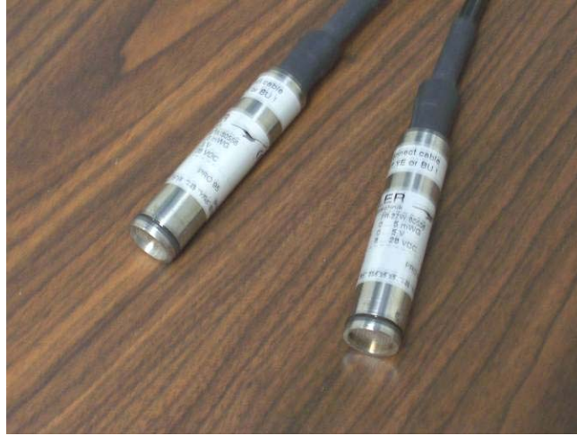
Figura V.6 Celdas de presión
