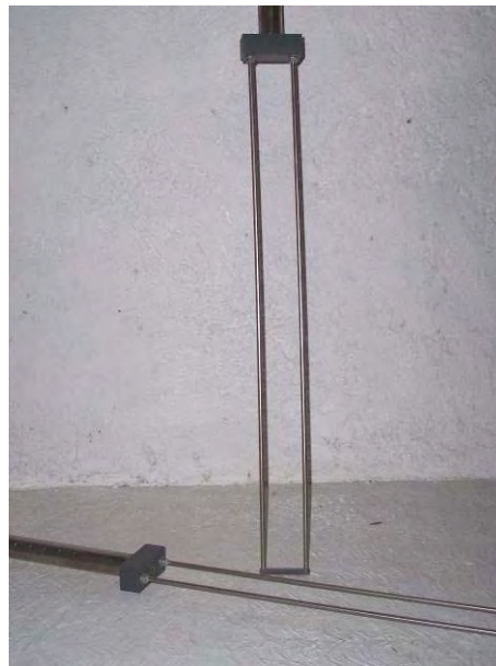
Figura V.5 Sensores de nivel
