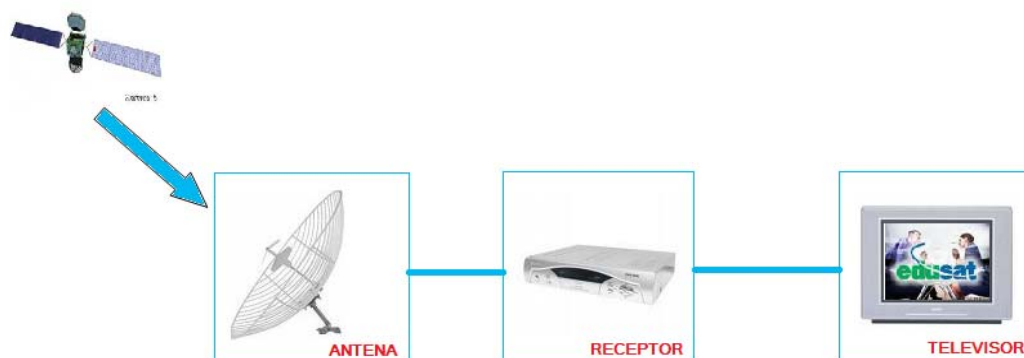
Fig. 4.33. Diagrama básico de un punto receptor
