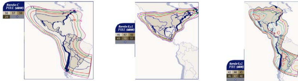
Fig. 4.31. Huellas de cobertura del Satmex 5 según la banda que se utilice
