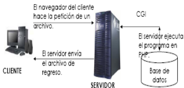
Figura 24. Funcionamiento del lenguaje PHP con el servidor
