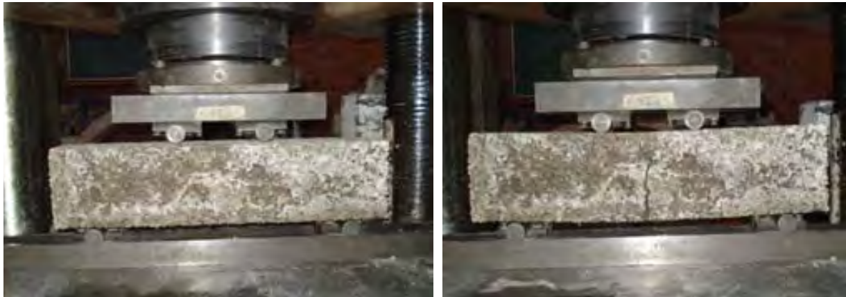
Figura 6.16 Ensayo de resistencia a flexión en base a la norma ASTM C78.
