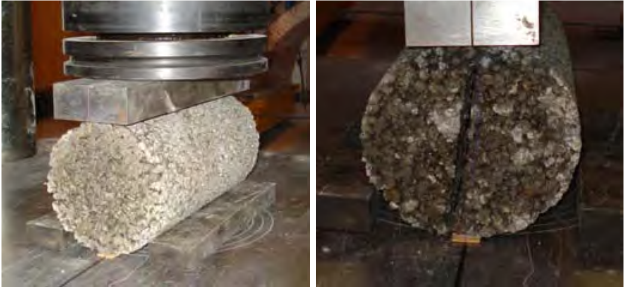
Figura 6.14 Ensayo de resistencia a tensión indirecta por compresión diametral.
