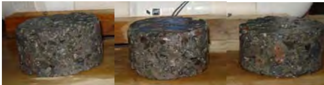
Figura 6.23 Muestras utilizadas para la prueba de permeabilidad.
