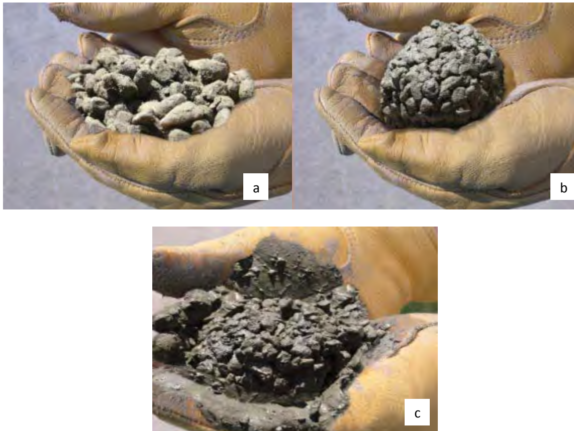
Figura 2.2 Muestras de concreto permeable con diferentes cantidades de agua: (a) con poca agua, (b) adecuada cantidad de agua, (c) con demasiada agua (Tennis et al., 2004).
