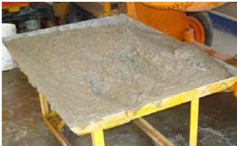
Figura 6.7 Consistencia de la mezcla de concreto convencional con aditivo agente espumante.
