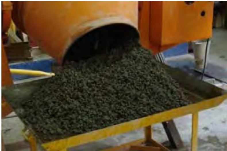
Figura 6.4 Consistencia de mezcla de concreto permeable de 3/8" con 15% de vacíos.
