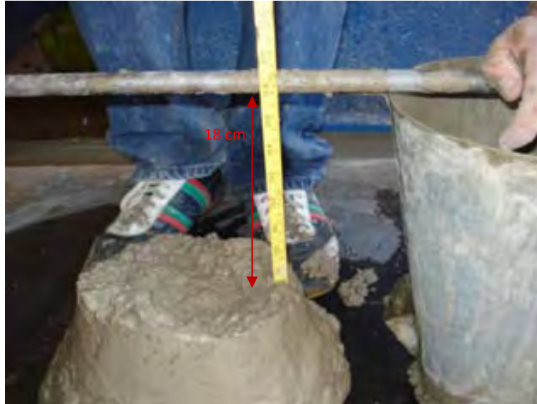
Figura 6.6 Revenimiento de la mezcla de concreto convencional con aditivo agente espumante con un promedio de 18 cm.
