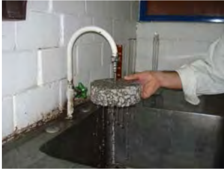
Figura 6.24 Capacidad de filtración de una muestra de concreto permeable.
