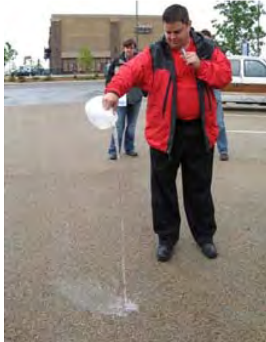
Figura 3.6 Capacidad de filtración del concreto permeable en un estacionamiento ( http://www.ourwater.org/econnection/connection26/tour.html ).
