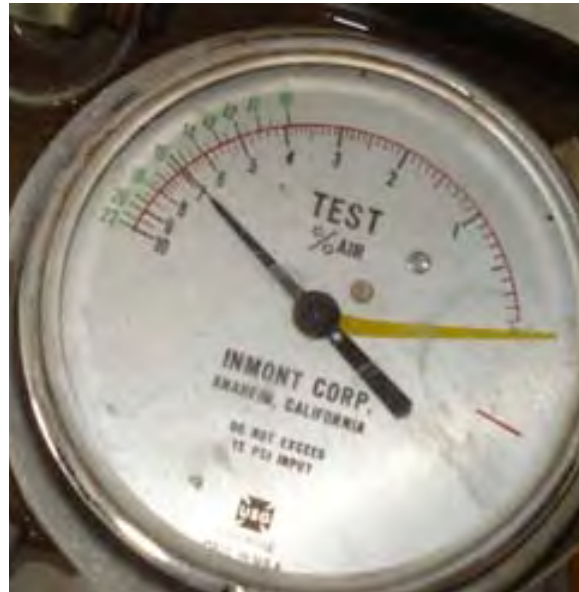
Figura 6.9 Resultado de la prueba de contenido de aire del concreto convencional con aditivo agente espumante (16%).
