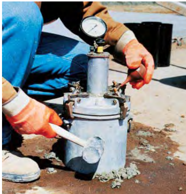
Figura 6.8 Medidor del tipo de presión para la determinación del contenido de aire.
