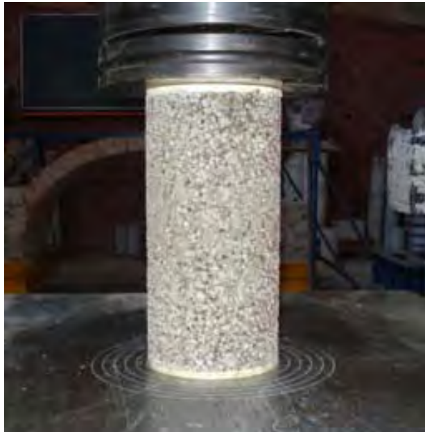
Figura 6.11 Ensaye de resistencia a compresión.
