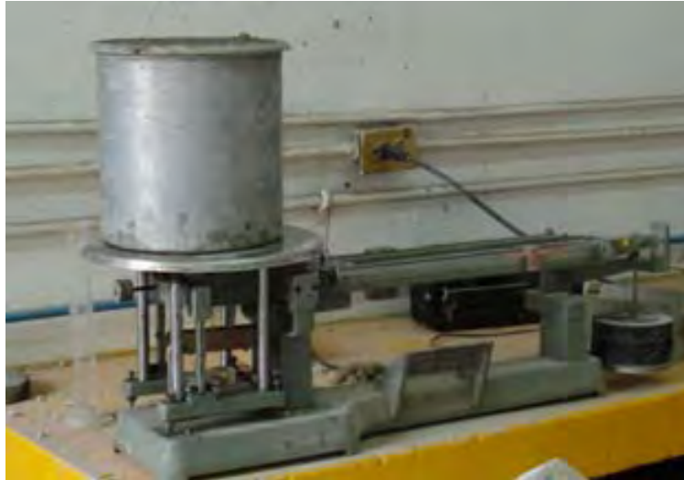
Figura 6.10 Equipo para la determinación del peso volumétrico.
