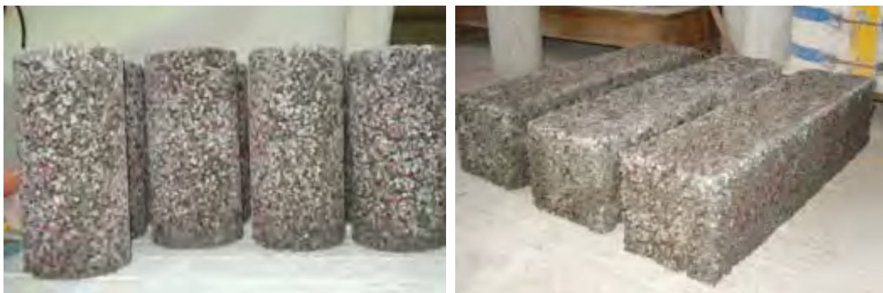
Figura 5.3 Cilindros y vigas de concreto permeable.
