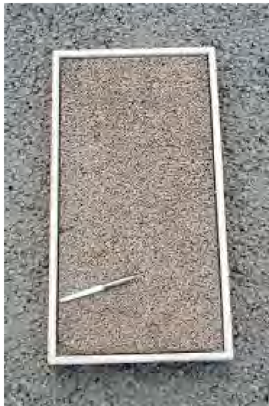
Figura 2.1 El concreto que contiene la caja es del tamaño de 1/4" (6.5 mm), mientras el que está debajo de la caja es de un tamaño más grande, 3/4" (19 mm) (Tennis et al., 2004).
