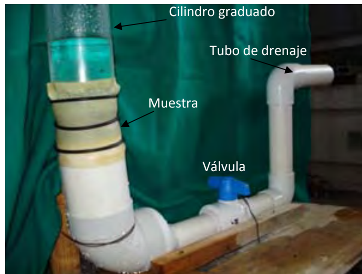
Figura 6.21 Permeámetro de carga variable para medir la permeabilidad.
