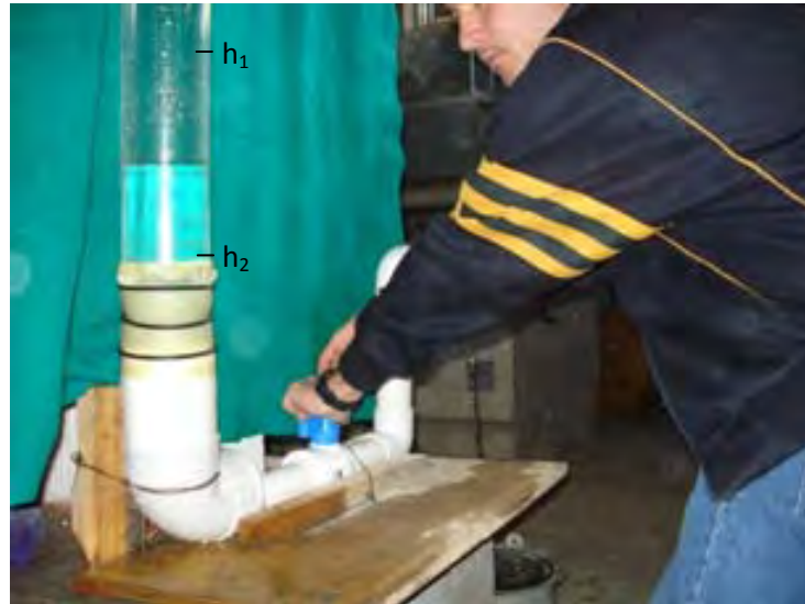
Figura 6.22 Prueba de permeabilidad.
