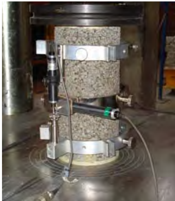
Figura 6.19 Ensaye de módulo de elasticidad.
