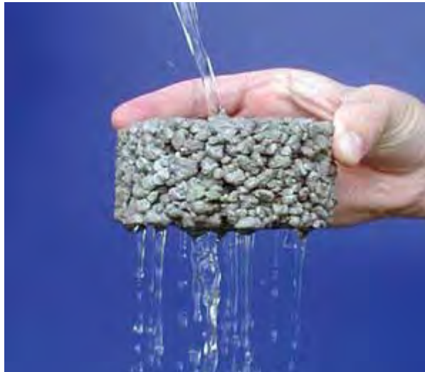
Figura 1.1 Textura de una muestra de concreto permeable ( http://www.nrmca.org/greenconcrete/default.asp )
