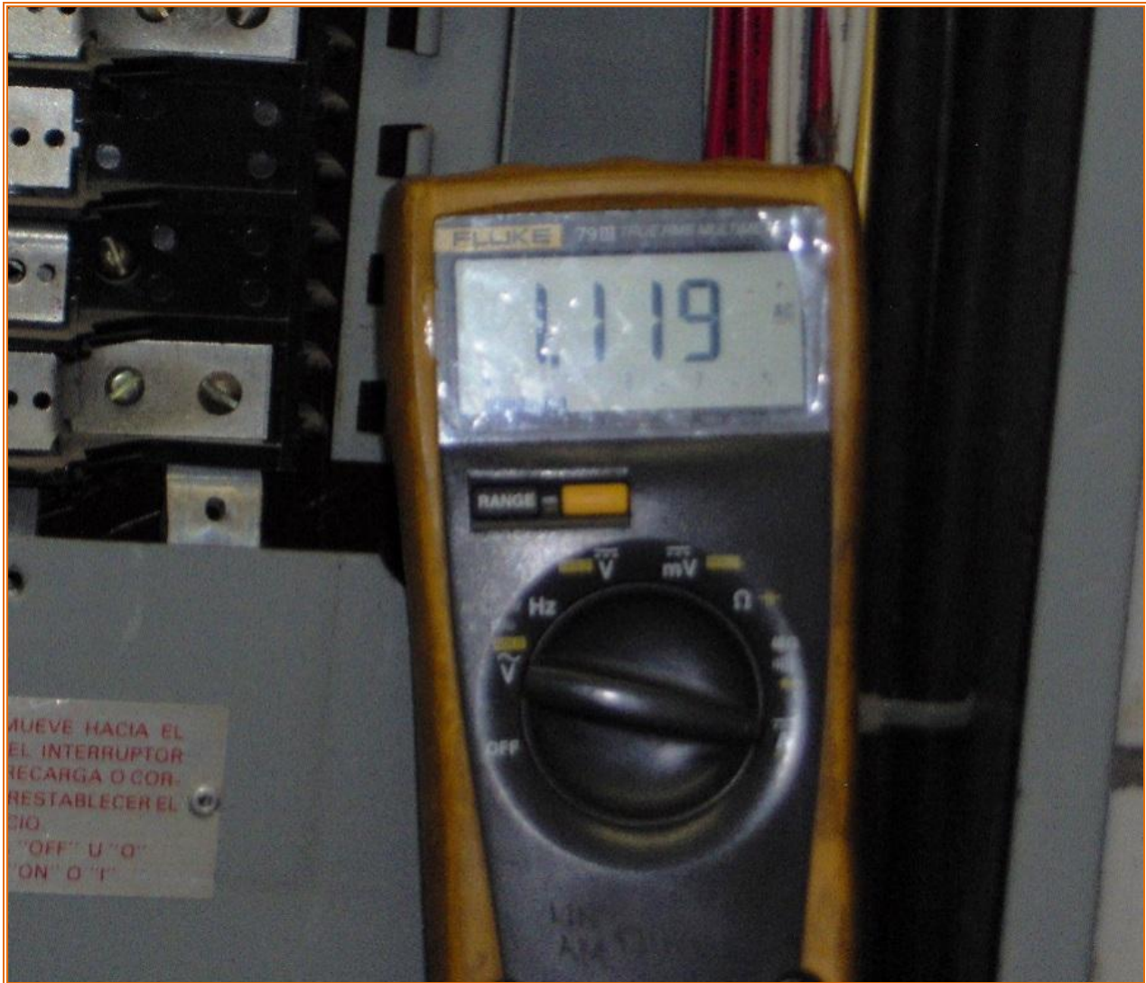
Fotografía 0-5. Medición de corriente con carga de prueba
