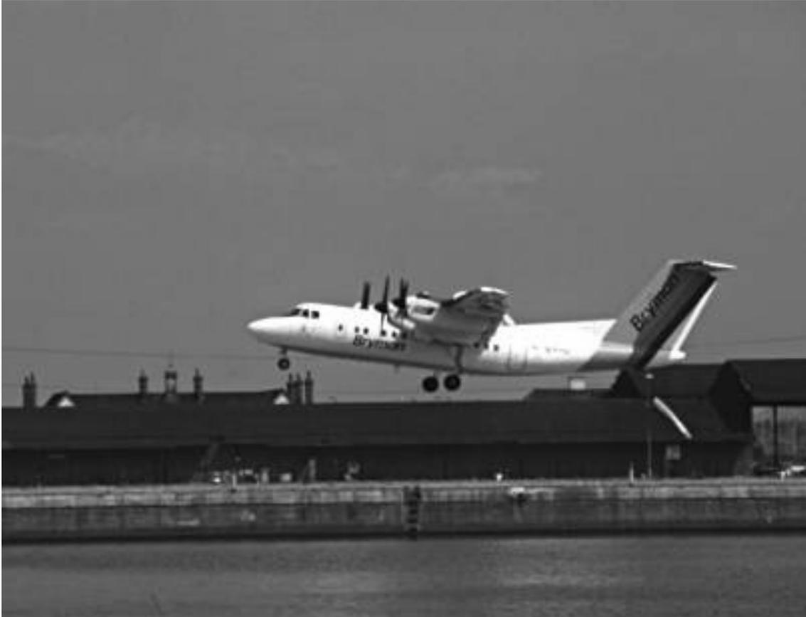
**Avión STOL:** Un avión de aterrizaje y despegue cortos despegar del aeropuerto de una ciudad. Estos aviones necesitan menos de 150 metros para aterrizar o despegar. Son útiles para aterrizar en pistas cortas. Otra aeronave especial, el avión VTOL, despegar y aterriza verticalmente, y se usa para aterrizar en pequeños barcos militares.
