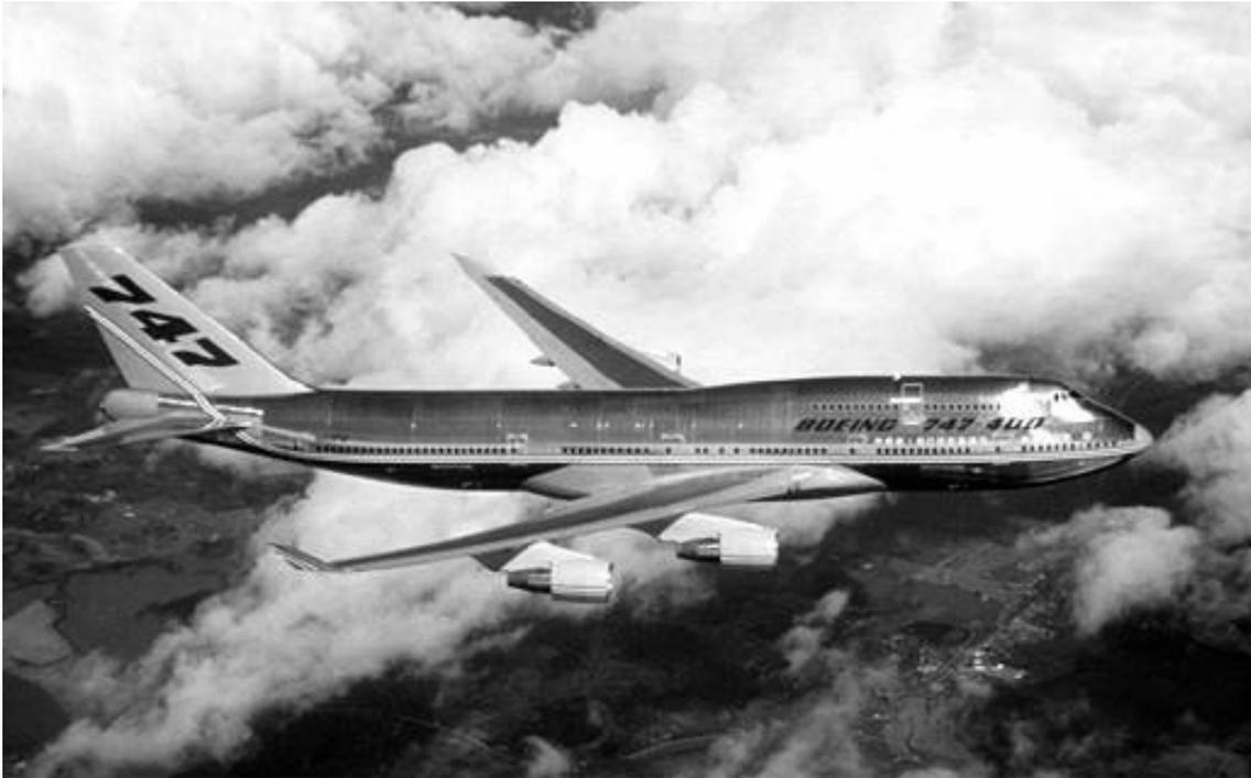
**Reactor Jumbo 747:** Este Boeing 747, conocido como Jumbo, transporta mercancías. El 747, el primero de los reactores comerciales de fuselaje ancho, hizo su vuelo inaugural en 1970. Cuatro motores a reacción impulsan el avión, que alcanza velocidades de crucero de 885 Km./h.
