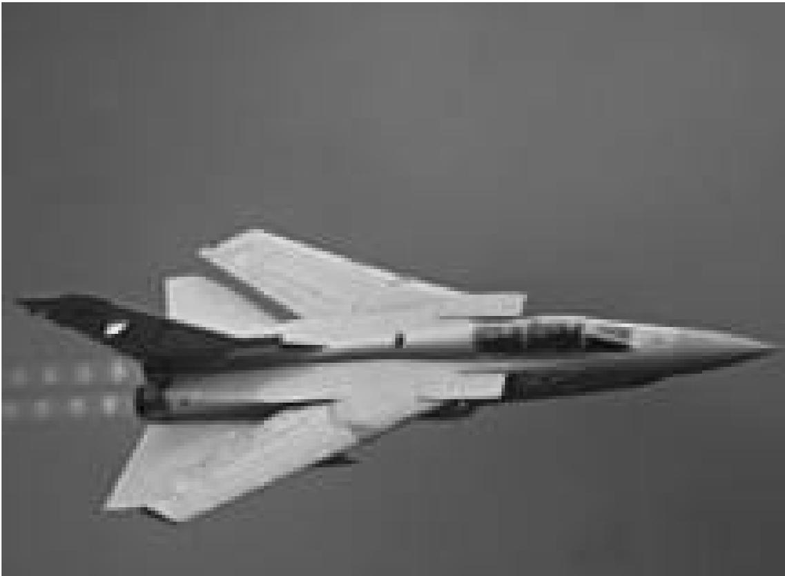
**F-3 Tornado:** Los aviones de combate, como este F-3 Tornado de la Royal Air Force, se construyen potenciando al máximo la velocidad, la resistencia y la maniobrabilidad. Diseñado y construido por un consorcio europeo, tiene un ala abatible, que aquí se muestra en su posición de alta velocidad, plegada hacia atrás. Hay versiones distintas del avión para misiones de interceptación, ataque y reconocimiento.
