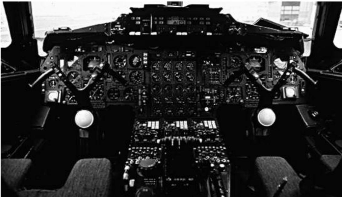
**Panel de control de vuelo:** La cabina de un Concorde muestra la complejidad de los controles de vuelo. El equipo electrónico e informatizado de la cabina proporciona información sobre navegación, velocidad, altitud, aterrizaje, y rendimiento del motor.
