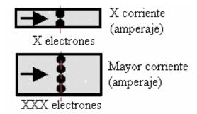
La resistencia se define como la oposición al flujo de la corriente eléctrica; a mayor resistencia, más dificultoso será el flujo de la corriente eléctrica.
