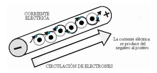
En un lenguaje más técnico, se puede definir a la corriente eléctrica como el flujo de electrones a través de un conductor; la cual es originada por la diferencia de potencial creada por una fuente generadora de corriente.
