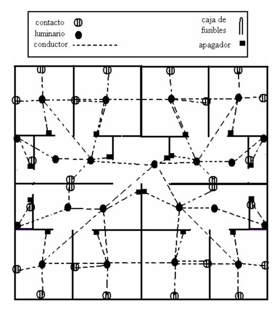
Del diagrama se puede hacer notar que la alimentación de la planta alta está dada a través del ducto de las escaleras, lo cual supone una gran desventaja en utilidad y eficiencia.
