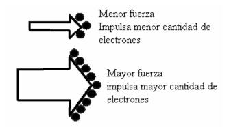
La corriente, también llamada intensidad o amperaje, es la cantidad de electrones que atraviesa una sección de un conductor en un instante dado y no durante un determinado tiempo. Sus unidades son los amperes y el aparato que la mide se llama amperímetro o ampermetro.
