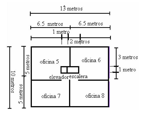
Se puede ver que la planta baja y la planta alta difieren un poco en cuanto a su distribución; esto es debido a que en la planta alta no está determinado un espacio para el pasillo.
