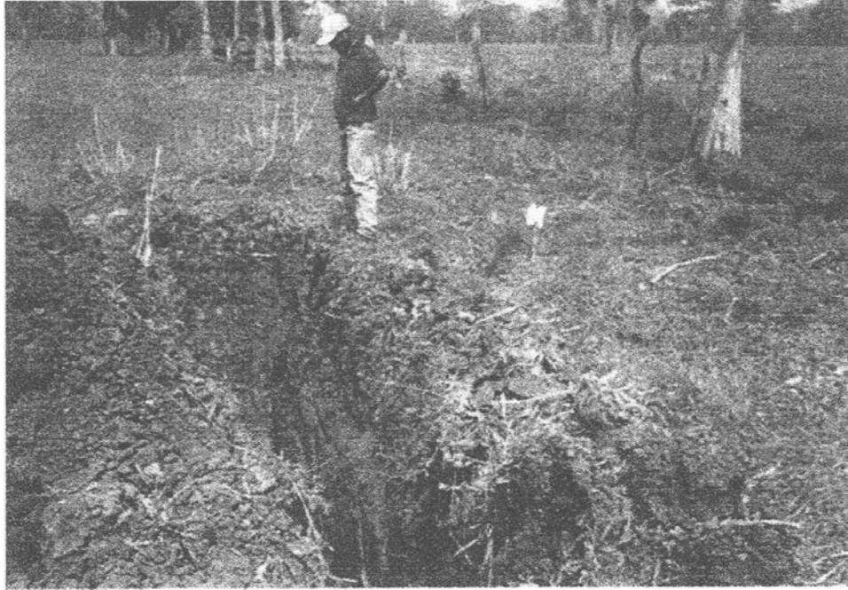
FOTO 31 VISTA DE LA ESTRATIGRAFIA DEL PCA – 10, DONDE SE EXCAVO HASTA 2.70M DE PROFUNDIDAD, EL NAF SE DETECTO A 2.70M
