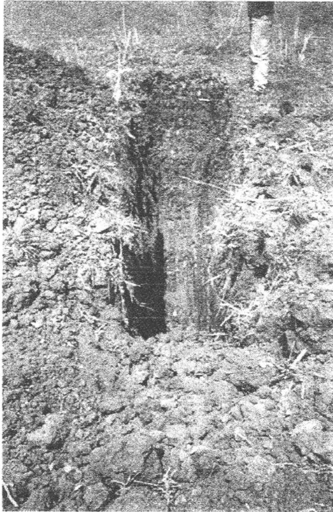
FOTO 32 VISTA DE LA ESTRATIGRAFIA DEL PCA – 19, DONDE SE EXCAVO HASTA 2.70M DE PROFUNDIDAD, EL NAF SE DETECTO A 2.70M
