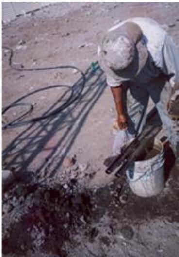
Control de las muestras obtenidas por medio del método de penetración estándar.
