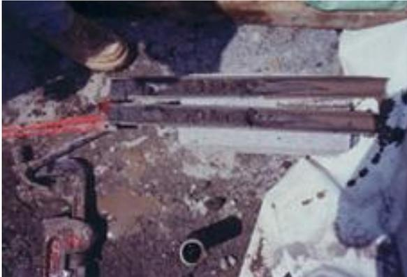
Muestra obtenida del tubo partido, se observa el tipo de material recuperado.
