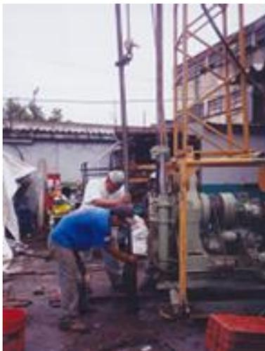
Desajuste del tubo Shelby, nótese como trae material Arcilloso en sus paredes.
