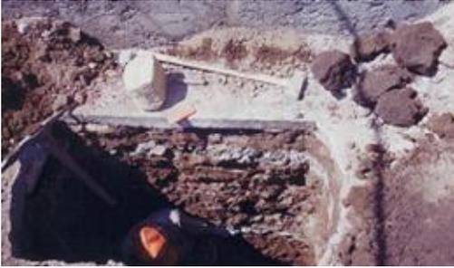
Obtención de la muestra cúbica del PCA # 2
