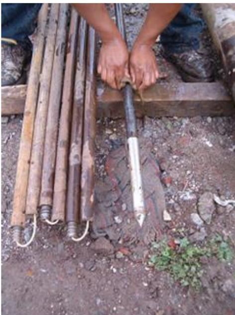
Vista del cono electrico, acoplado a la tubería utilizada, una vez terminado el sondeo de cono se efectua la limpieza de este.
