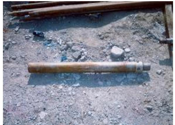
Tubo Shelby utilizado para la obtención de muestras intactas.
