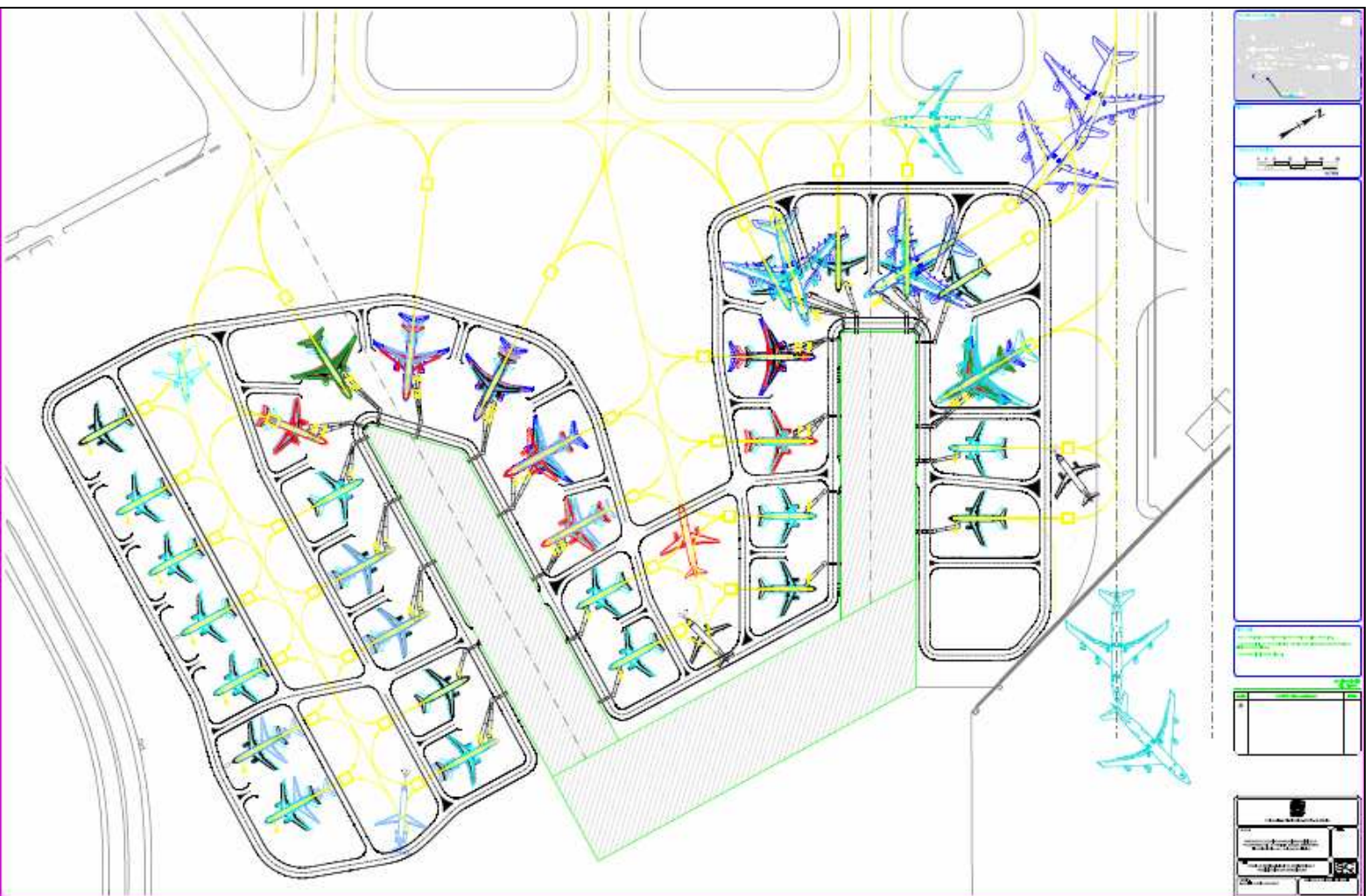
PLANTA SEÑALAMIENTO HORIZONTAL Y ACOMODO AEREO
