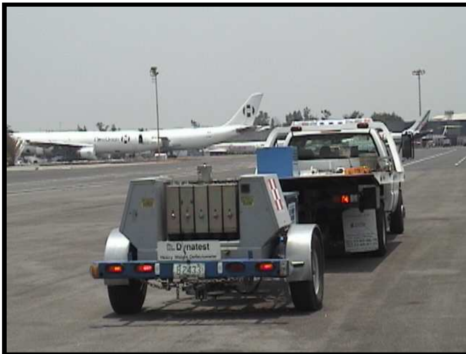
Deformómetro de impacto en operación
