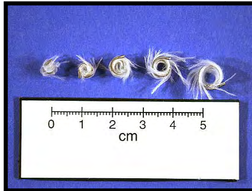
Fig. 6. Diferentes tamaños de coils oclusores de Gianturco de 0.038 pulgadas. De izquierda a derecha: 3 mm de diámetro, 4 cm de longitud; 4 mm de diámetro, 3 cm de longitud; 5 mm de diámetro, 5 cm de longitud; 6 mm de diámetro, 5 cm de longitud y 8 mm de diámetro, 5 cm de longitud. Los penachos de dacrón no ocluyen completamente el lumen.
