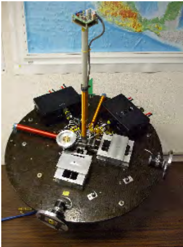
Figura 5.13.- a) Juego de ruedas inerciales en la plataforma y b) detalle de la rueda Inercial en el eje de Alabeo.
