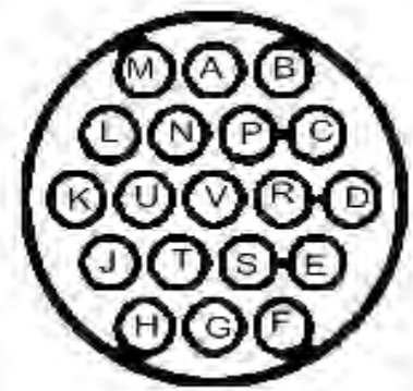
Figura 3.26. Distribución de pines para los conectores C1.X y C3.M
