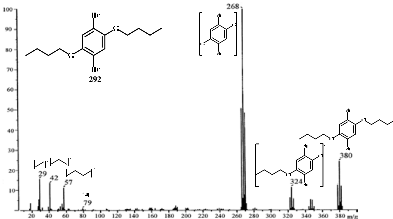
Figura 45. Espectro de masas del 1,4-dibromo-2,5-dibutoxibenceno 292 .
