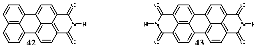
Figura 7. Estructuras del perilen-3,4-dicarboximida 42 (PMI) y perilen-3,4:9,10-bis(dicarboxiimidas) 43 (PDI).
