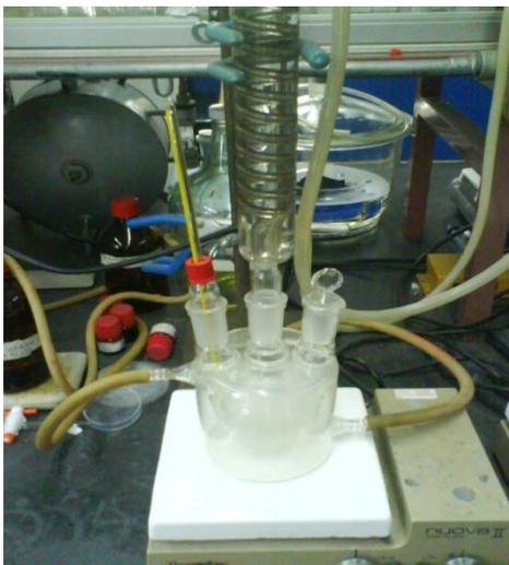
**Figura 3.1 Reactor Batch utilizado en las pruebas de actividad.**
