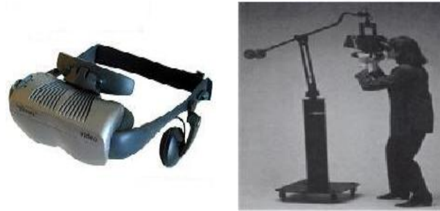
Figura 2.8: Izquierda: Ejemplo de un HMD. Derecha: Floor Supported Display
