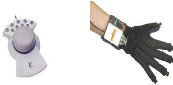
Figura 2.6: Izquierda: Ejemplo de un Tracker. Derecha: Ejemplo de un guante cyberglove
