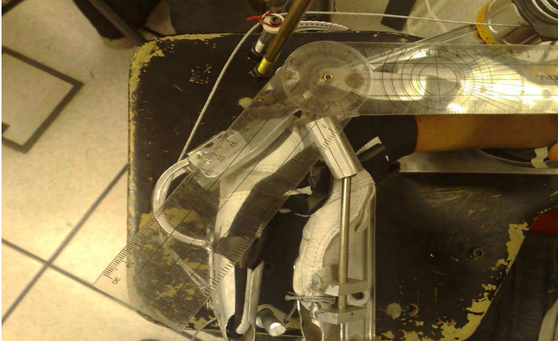
Figura 58 Colocación del goniómetro y sensores de fuerza
