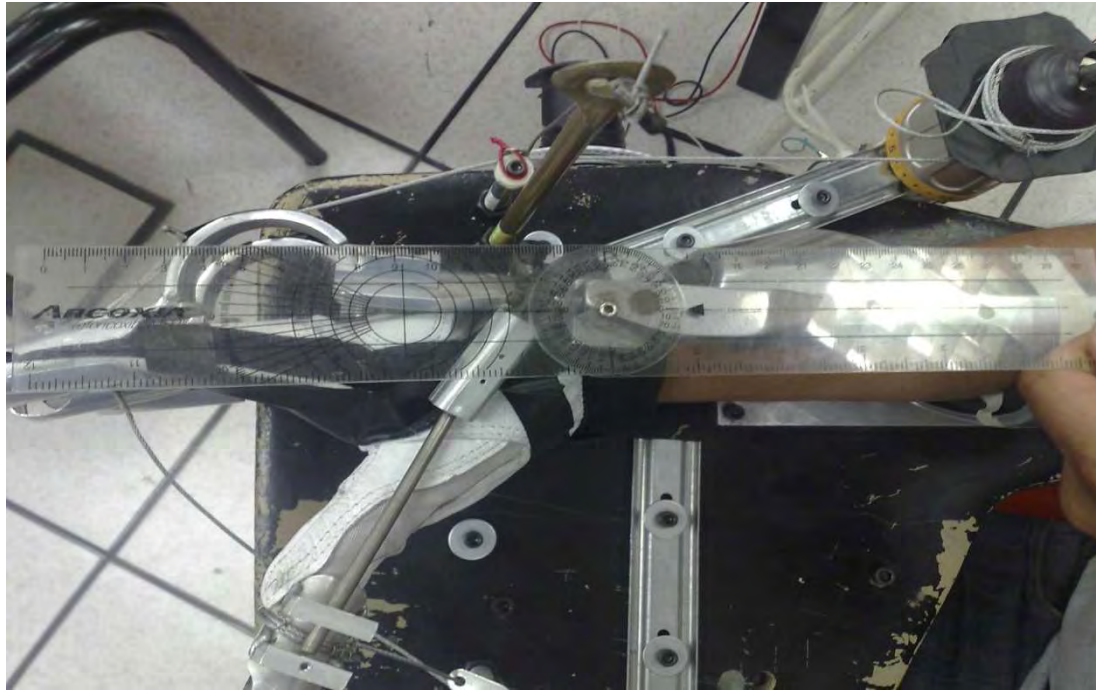
Figura 57 Colocación del goniómetro y sensores de fuerza
