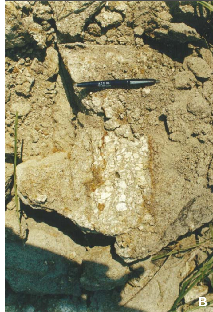
Fig- 7-2 Intemperismo esferoidal observado en la capa de toba del Km 174 de la Autopista La Tinaja-Coatzacoalcos (A). Se aprecia también la textura de la toba (B), la cual contiene cristales que varían entre 0.5 y 1.5 cm de espesor; la mayoría corresponden a feldespatos potásicos. Las fotografías pertenecen a la muestra MISA-98"A" de la Sección Puente Vistahermosa.
