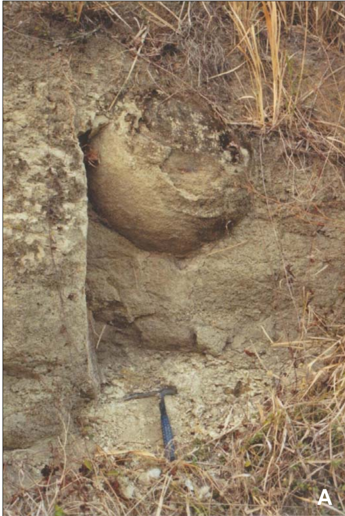
Fig- 7-2 Intemperismo esferoidal observado en la capa de toba del Km 174 de la Autopista La Tinaja-Coatzacoalcos (A). Se aprecia también la textura de la toba (B), la cual contiene cristales que varían entre 0.5 y 1.5 cm de espesor; la mayoría corresponden a feldespatos potásicos. Las fotografías pertenecen a la muestra MISA-98"A" de la Sección Puente Vistahermosa.
