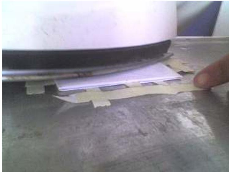
Figura 5.7.3 Aplicando calor a la placa con una plancha
