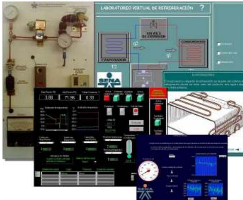
Figura 1.5.2.1 Presentación de panel frontal de los subvis desarrollados para la formación en refrigeración y aire acondicionado.
