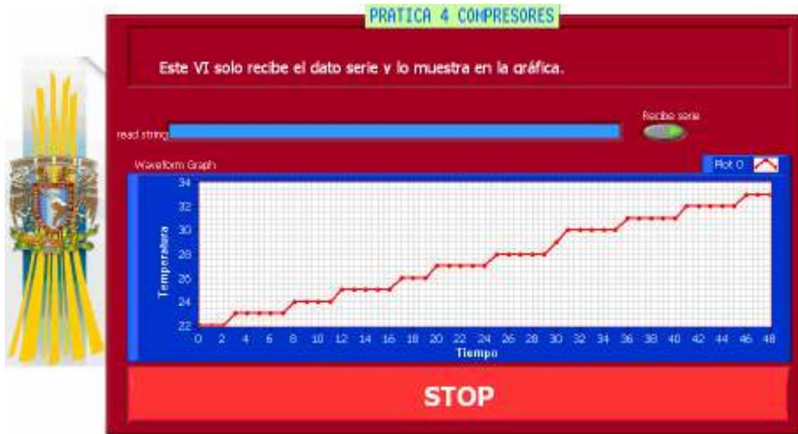
Figuras 5.10.1 Gráfica de una señal obtenida del termopar.
