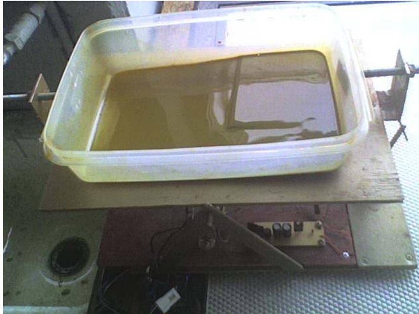
Figura 5.7.5 Retirando el cobre con ácido férrico
