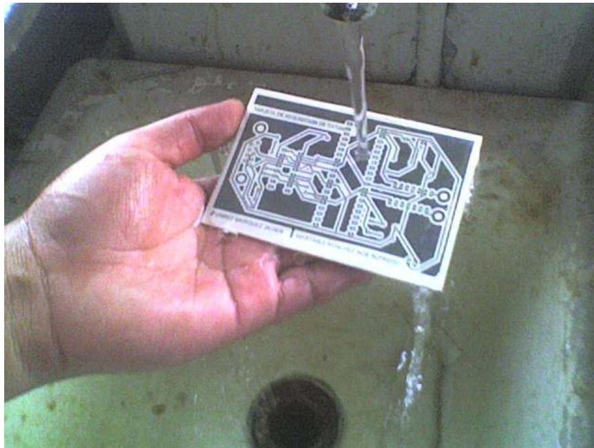
Figura 5.7.6 Limpieza del ácido después de retirado el cobre.
