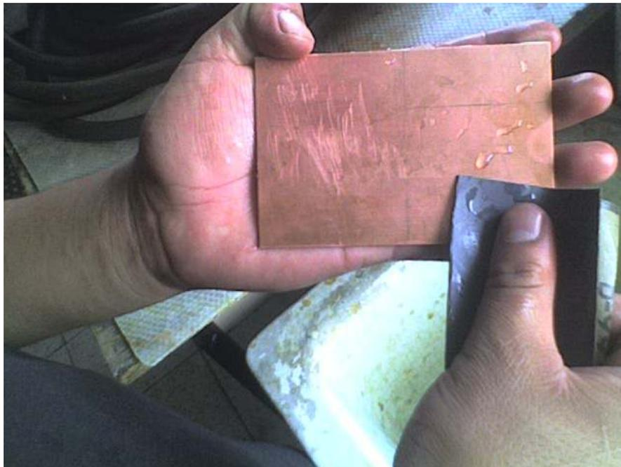
Figura 5.7.2 Limpieza de la placa fenólica.
