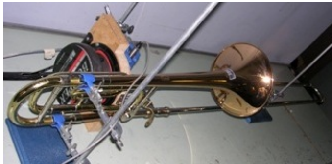
Figura 15: Trombón con longitud máxima sobre la mesa de trabajo. Al lado izquierdo se encuentra el altavoz.
