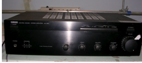
Figura 6: Amplificador que manda la señal proveniente del generador hacia el altavoz.
