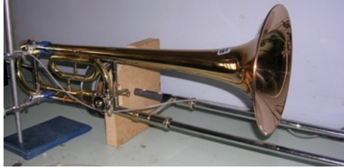
Figura 13: Trombón sujeto por soportes y unido por medio de una adaptación al altavoz.
