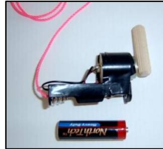
Fig. 4.2.4. Dispositivo para generar ondas estacionarias.
