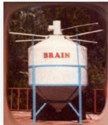
Figura 5 Bio-Reactor Anaerobio Integrado
