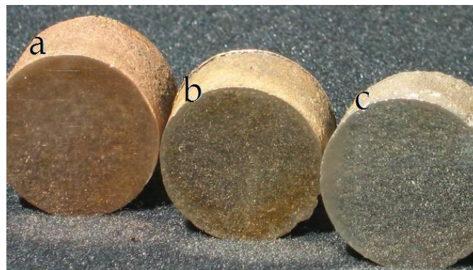
Figura 2 Fotografía (1.5X) de las muestras de los bronce colados (a) Cu-5% Sn, (b) Cu-13% Sn y (c) Cu-22% Sn.
