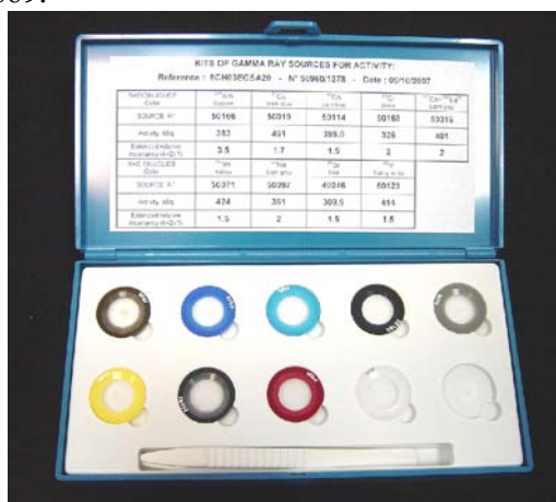
Fig. B.1 Fotografía del estuche de 9 fuentes radiactivas de rayos gamma de Areva-Cerca, con las cuales se realizó la calibración en energía de los detectores.
