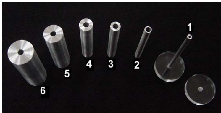
Fig. 4.1 Maniquí de sensibilidad formado por 6 cilindros de aluminio. Dentro del cilindro maestro se coloca al capilar y para cambiar el espesor de aluminio se colocan sobre éste los cilindros 2 a 6.
